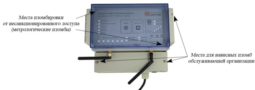
Рисунок 2 – Схема пломбировки УСПД
