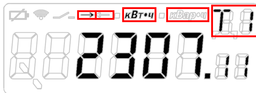
Рисунок 5 – Дисплей счетчиков НАРТИС-100 и НАРТИС-300. Важные для снятия показаний символы отмечены красными прямоугольниками
