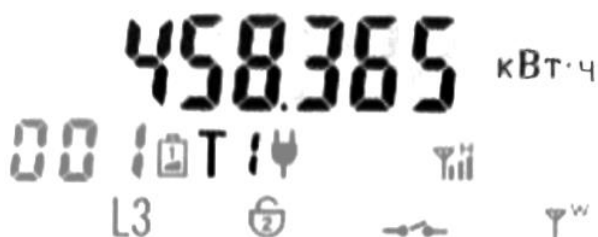
Рисунок 4 – Пример отображения показания счетчика при помощи ВЦД Д101
