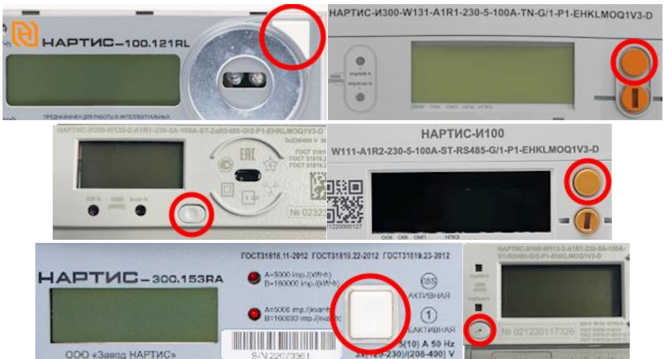
Рисунок 2 – Позиция кнопки переключения дисплея на некоторых моделях счетчиков (отмечена красным кругом)
