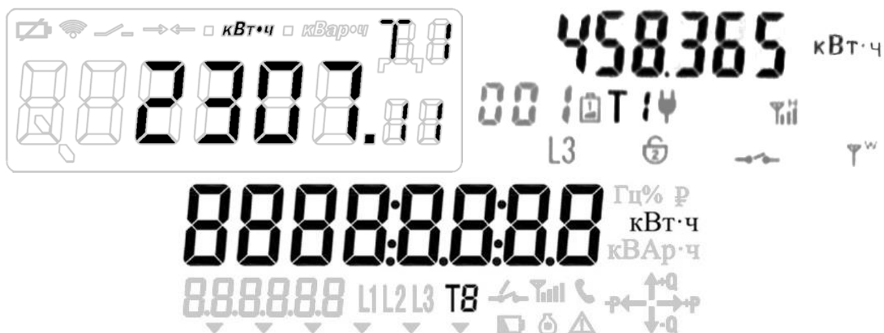
Рисунок 1 – Дисплеи, используемые в счетчиках «НАРТИС» и «НАРТИС-И». Черным цветом отмечены поля с требуемыми для снятия показаний надписями. Допускаются незначительные отступления в части отображения символов и надписей, связанных с технологическими ограничениями
