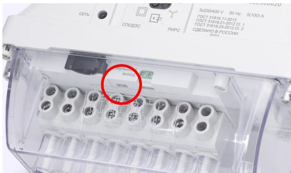
Рисунок 4 — Местоположение ползункового переключателя аппаратной блокировки реле в корпусе SP31
