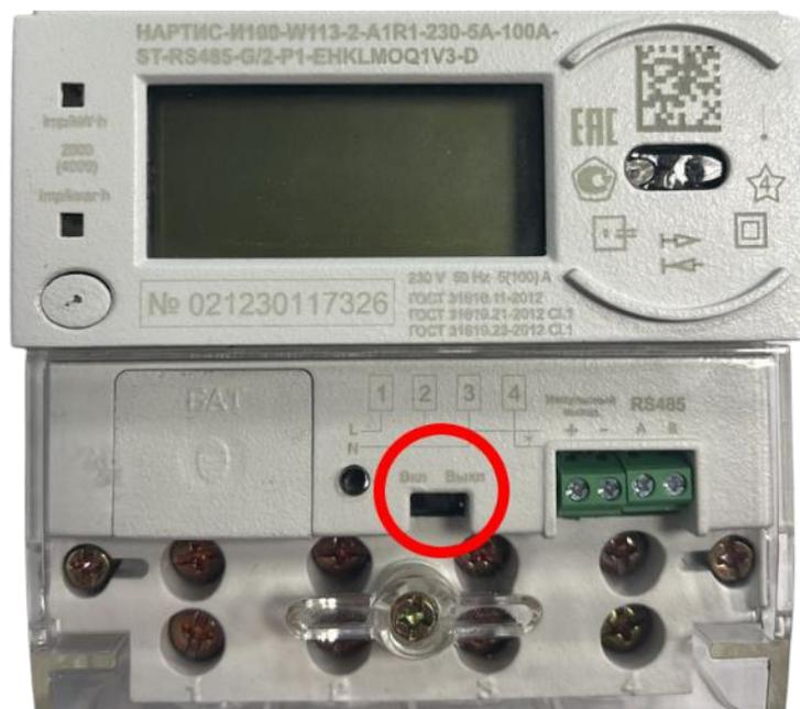
Рисунок 3 — Местоположение ползункового переключателя аппаратной блокировки реле в корпусе W113
