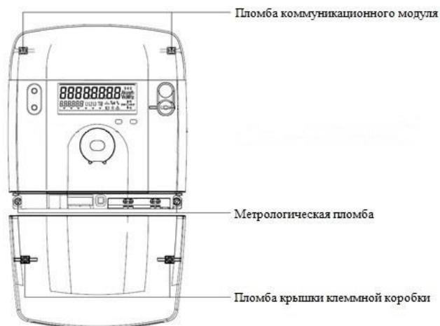
Рисунок 4 – Схема пломбирования счетчика в корпусе типа W131
