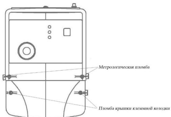
Рисунок 5 – Схема пломбирования счетчика в корпусе типа W132
