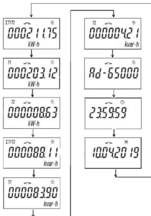
Кнопки «↑», «↓» позволяют переключиться на последующие циклы. В них входят дополнительные параметры (частота, напряжение, ток, активная и реактивная мощности).
