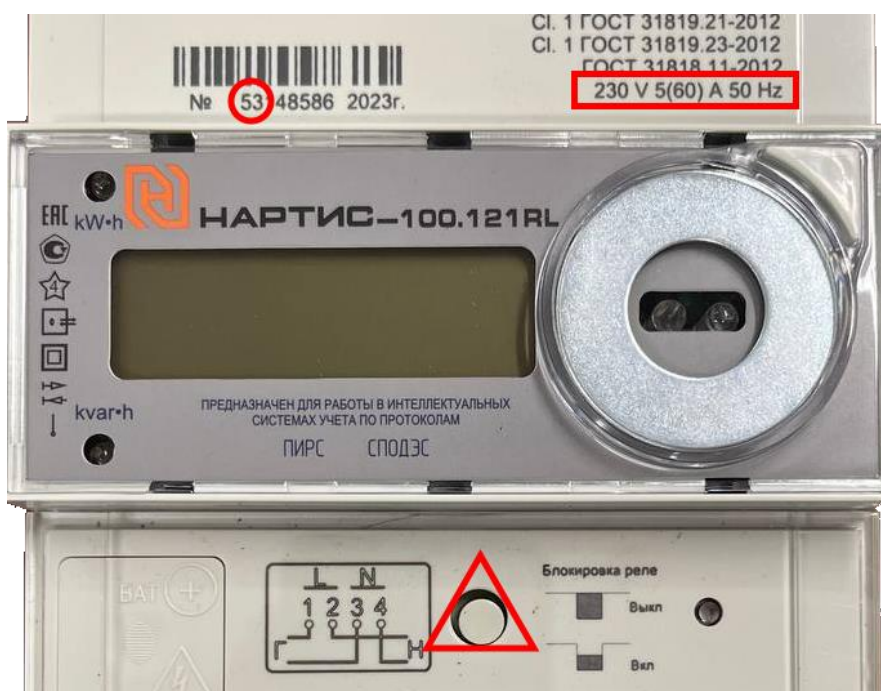
Рисунок 1 — Счетчик НАРТИС-100.121. Красным прямоугольником обозначена маркировка основных характеристик счетчика, максимальный ток указан в скобках и равен 60 А. Красным кругом обозначены первые две цифры номера счетчика. Красным треугольником обозначена позиция кнопки (отверстия) аппаратной блокировки реле
