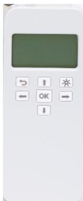
Модуль отображения информации служит для вывода на экран данных с вашего счётчика электроэнергии.
